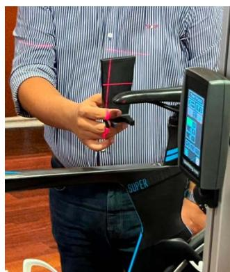
Paso 5: Medición del extensión del manillar. El árbitro debe situar el láser en el punto más avanzado, teniendo las palancas del cambio en la posición más alejada.
