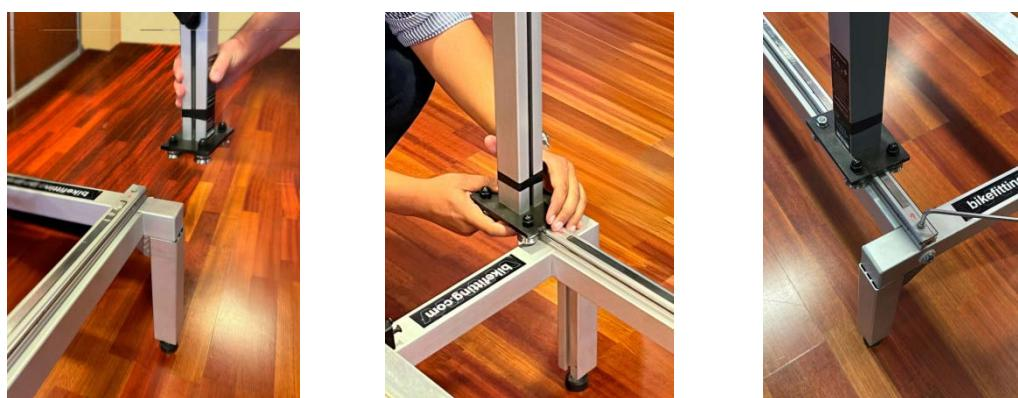
Se debe comprobar que la barra vertical se mueve con facilidad a lo largo de la guía. El sistema debe tener la apariencia de la imagen adjunta.
