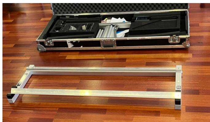
A continuación se deben montar las patas. Hay que apretar bien los tornillos que quedan ocultos, puesto que el conjunto de piezas constituirá la estructura básica del gabarit.
